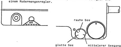
9. Betriebsarten-/Rudermengenregler Dieser Drehknopf ist dicht bei der Windfahnenbuchse plaziert und wird auf "SET" gestellt, um das Ausrichten des Autopilot-Kompasses mit dem Schiffsbug zu erleichtern und um die Endkappe der Schubstange auf den Pinnenbolzen zu bringen. Auf Position "AUTO" kann eine der vier Rudermengen gewählt werden (Die Menge der Ruderbewegung wird vorgegeben, um einen bestimmten Wert der Kursabweichung auszugleichen).
